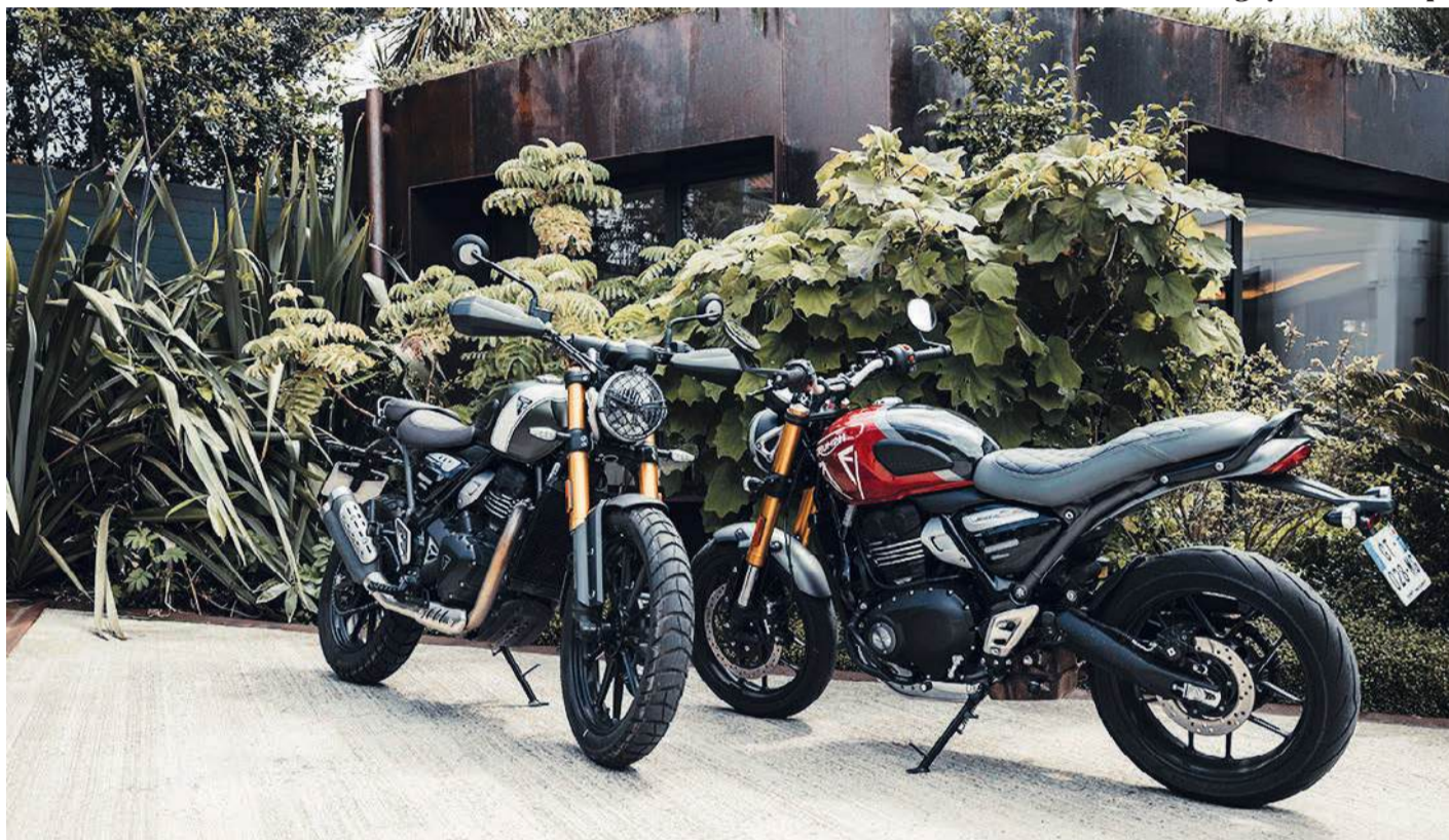
As motos da linha T-Series da Triumph são equipadas com controle de tração, que atua para reduzir automaticamente a potência da moto em situações de perda de aderência
